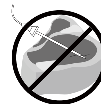
(Abbildung C) Fehlerhaft angebrachter Sensor
