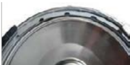
Posizione corretta della guarnizione
