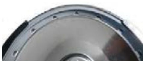
Posición incorrecta de la junta
