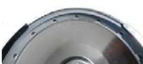
Posizione errata della guarnizione
