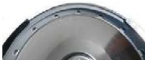
Position incorrecte du joint
